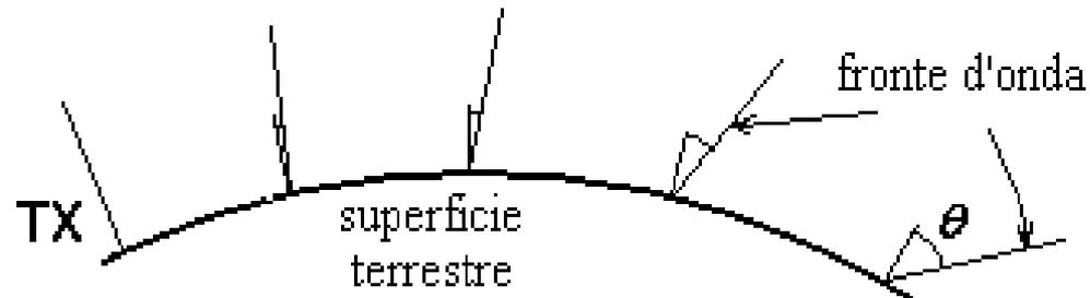
**Per onde lunghe e lunghissime la propagazione per onda di superficie è molto importante e viene comunemente utilizzata. Occorre polarizzazione verticale che si ottiene con antenne “Marconi”. Rimane, comunque, la difficoltà di ottenere antenne di buon rendimento a queste basse frequenze (l’antenna ha dimensioni tipiche di  $\lambda/4$ ) e la necessità di operare con potenze molto grandi in modo da superare in ricezione il notevole rumore naturale ed artificiale presente su queste bande.**
